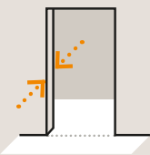
WST: Wandstärke einschließlich Putz, Kacheln etc.
